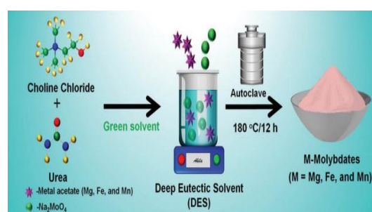
图 1 DES 辅助合成 \text{MgMoO}_4 、 \text{Fe}_2(\text{MoO}_4)_3 、 \text{MnMoO}_4 的过程 [69]
